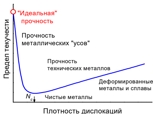
Рис. 5.2. Схематическое представление зависимости напряжения пластического течения кристаллического тела от плотности дислокаций.
