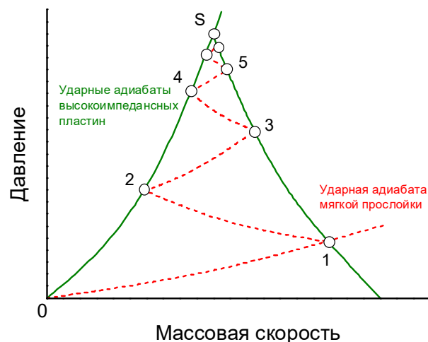
Рис. 2.5. Многократные отражения волн в тонкой прокладке между пластинами высокоимпедансного материала.
